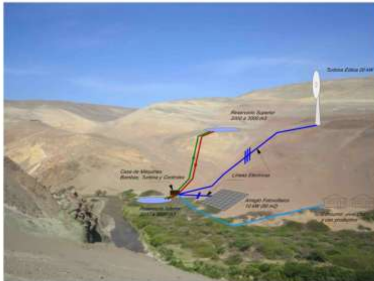
ESQUEMA DEL SISTEMA HIBRIDO (20 kW EOLICO, 10 kW SOLAR) CON ALMACENAMIENTO DE ENERGÍA POR MEDIO DE AGUA BOMBEO. (ubicación hipotética en Nasca)
